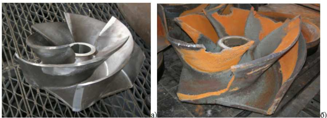
а) колесо до начала эксплуатации; б) изношенное колесо
